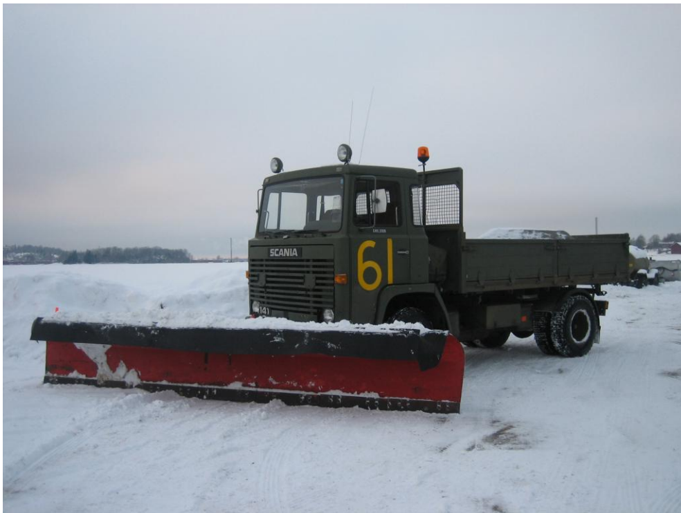
Det här är vårt stora plog ekipage. Scania V8 med 5,6 m plog
