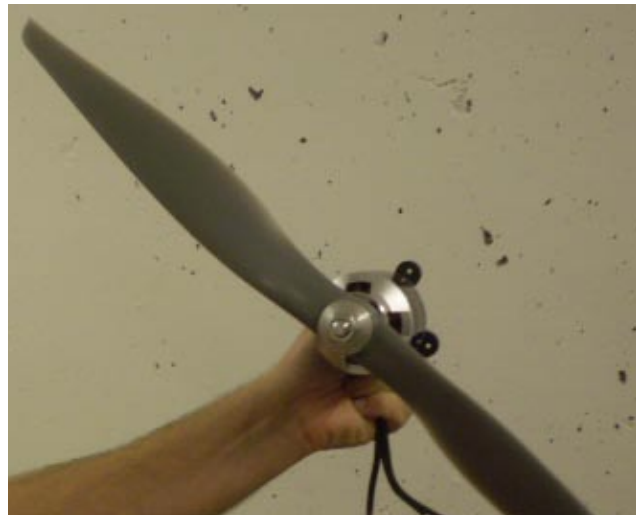
Två kraftiga elmotorer kommer att driva Catalinan. Det är två EMax 5335/10 med 3,5 kW/st och propellrarna är imponerande 20x10! Kanske blir det också en ljudmodul som ska ge ljudet från två Pratt & Whitney-motorer! Wow!
