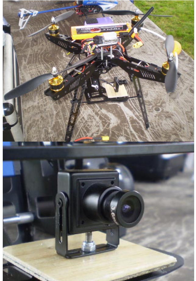
Gide har lagt ut några filmer på NMKS hemsida (Flyg/Fritt forum/"En film från Quaden"). Dessa är filmade med den minimala kameran som ses på bilden här ovan. Den övre bilden visar "helikoptern" som bär kameran, en Gaudi Quad Flyer 330x.
