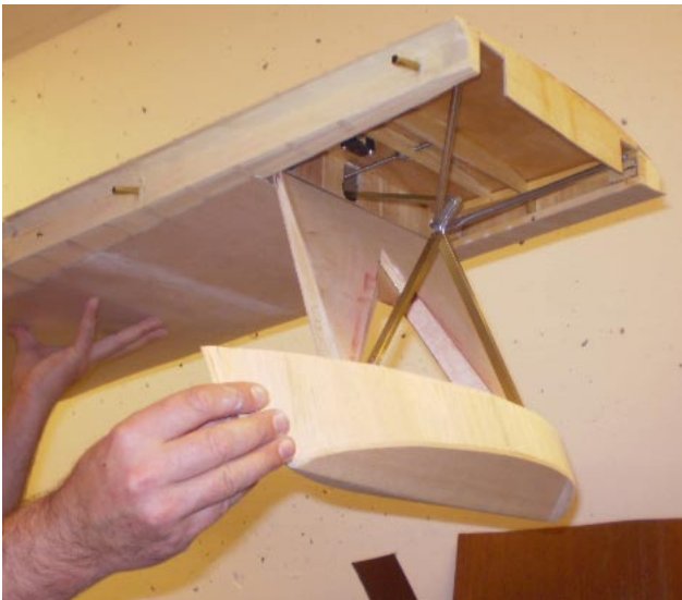
Här är pontonerna som fälls ner vid landning på vattnet. Under flygning och vid landning på marken är de uppfällda och bildar vingspetsarna.
