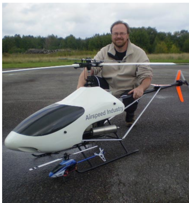
Thomas Leijon kom med träffens största helikopter. Det är en Vario XLV med 2,5 meters rotorvidd. Motorn är en Zenoa på 27 cc. Bara ett rotorblad väger 0,5 kg och hela ekipaget väger 13 kg! Det tar upp till två minuter för rotorn att stanna efter att motorn har stoppats - man kliver inte fram och trycker tummen mot rotorhuvudet för att bromsa rotationen. Maskinen är gjord för att "finflyga" och tål inte avancerad flygning, men vad gör det när ljudet är underbart och den är lätt att se även på avstånd.
