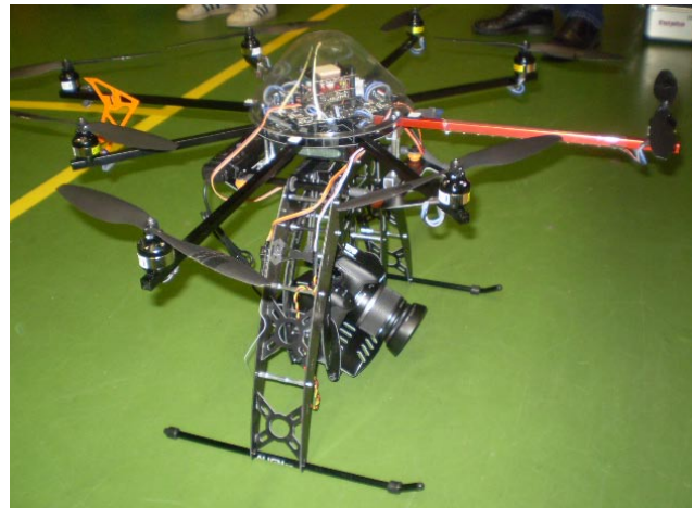
Här är Jan Höglunds octokopter med kamera monterad underst. I "ostkupan" överst skymtar man den avancerade tekniken - en imponerande samling kretskort.
