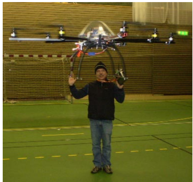
Päras octokopter svävar under full kontroll trots att Pära släppt greppet om radion. Koptern är försedd med GPS och kan programmeras att köra vissa rundor till förutbestämda positioner. Den har också gyro, höjdmätare mm mm. Vilket tekniskt underverk!
